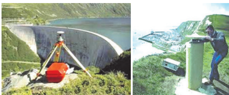
Фиг. 2.26. Приложение на ГНСС в контрола на деформации на инженерни съоръжения (ляво) и топографията, кадастралните заснемания и трасировки (дясно)
