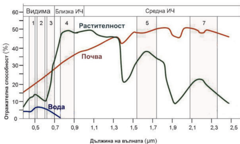
Фиг. 1.8. Шест от осемте канала на спътника LANDSAT 7 (в сиво) и три спектрални отражателни криви.
