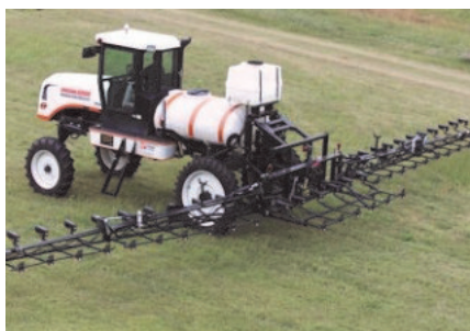
Фиг. 4.34. Комбиниране с датчици за регистриране на отражателната способност.. Източник: Държавен университет на щата Оклахома
