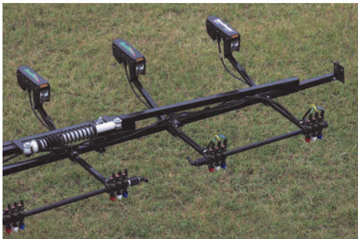
Фиг. 4.41. Сензори (горе) и апликатори за променливо третиране (долу) на комбайн. Източник: Университет на щата Оклахома (Oklahoma State University)
