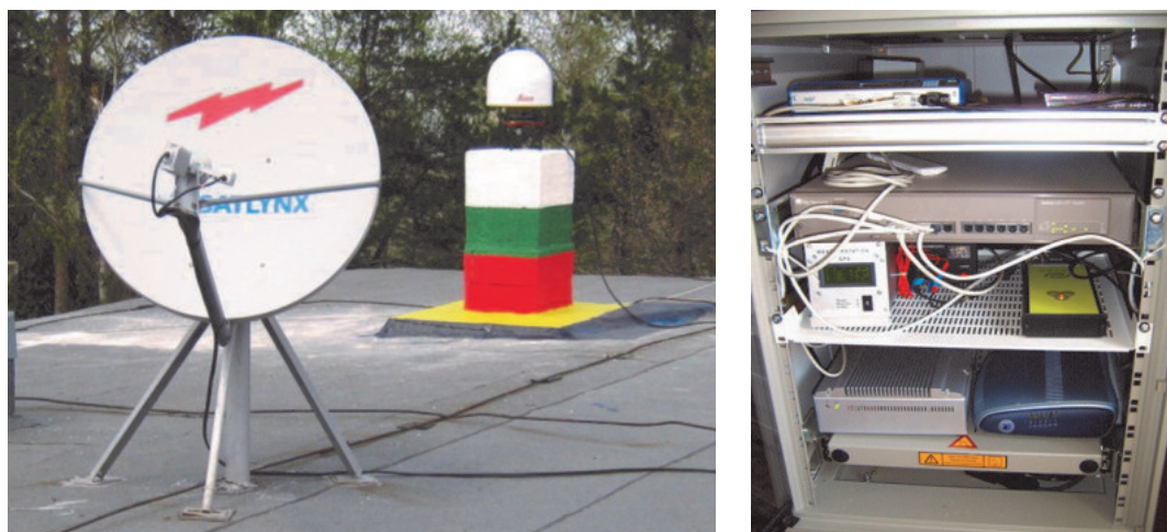
Фиг. 2.20. Постоянна ГНСС станция SOFI (от май 1997 г.) от Международната геодинамична служба (IGS) в района на гр. София, част от Световната и Европейската перманентни мрежи
