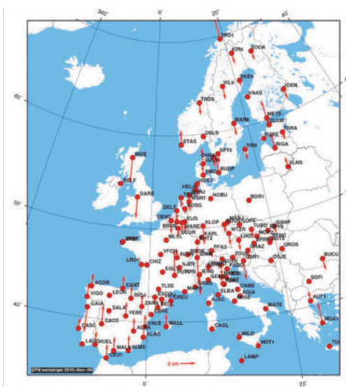
Фиг. 2.28. Мониторинг с перманентни станции на съвременните хоризонтални и вертикални движения в Европа
