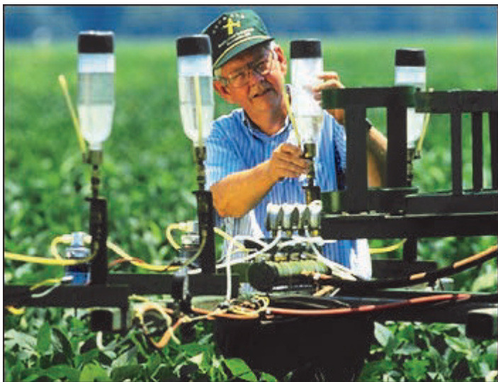
Фиг. 4.35. Настройка на супернискообемни апликатори на хербициди. С този метод използването на химикали в земеделието се намалява съществено. Източник: Кийт Уелър, Служба за земеделски изследвания на Министерството на земеделието на САЩ (Keith Weller, USDA Agricultural Research Service)
