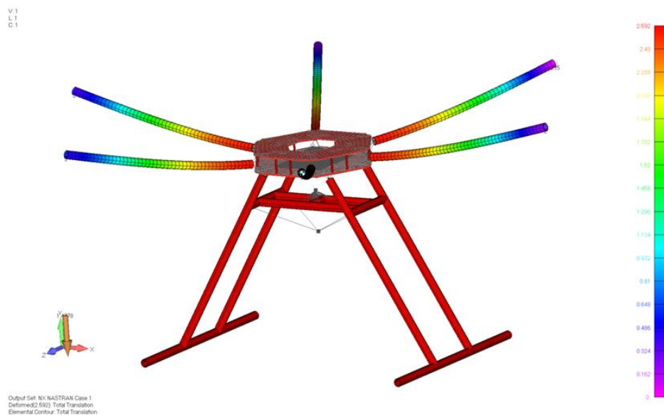
Фиг. 3. Деформация на конструкцията при симулация "Излитане с максимална тяга"
