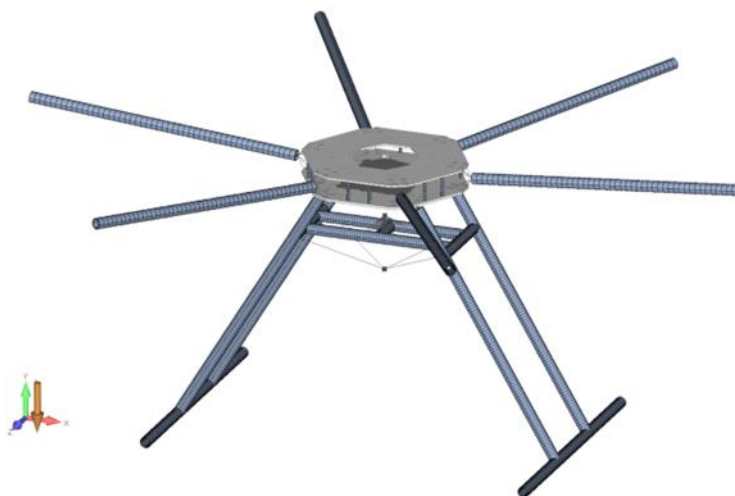
Фиг. 2. Цялостен силов модел на хексакоптер
