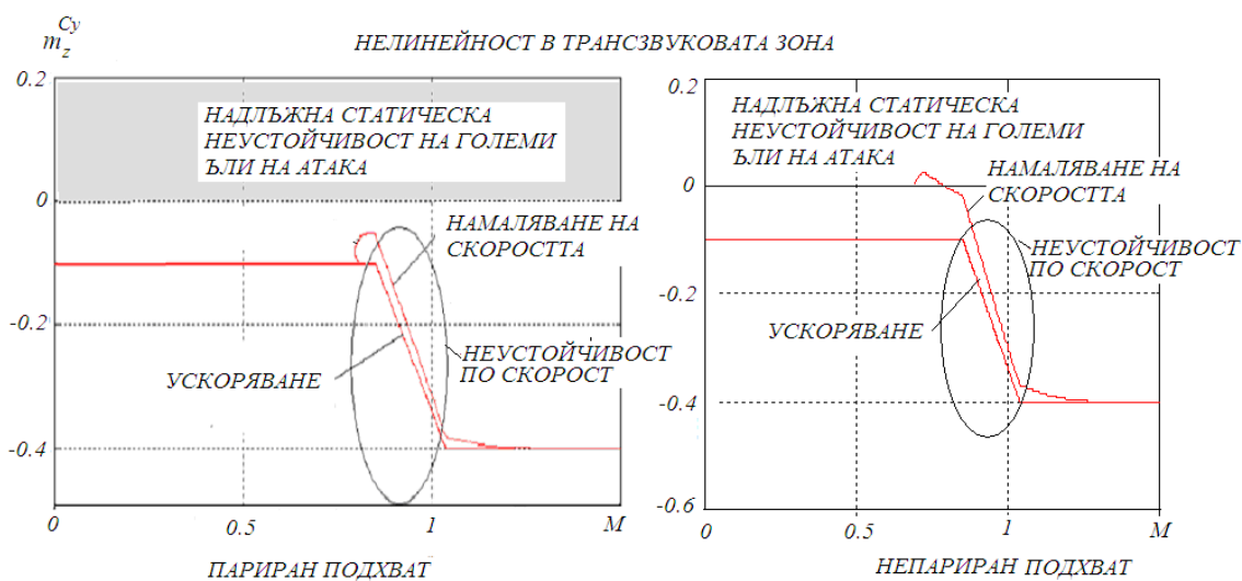
Фиг. 2. Изменение на надлъжната статическа устойчивост от преместване на аеродинамичния фокус в трансзвуковата зона (основна причина за скоростния подхват), моделирано в Matlab-Simulink , при работеща система за подобряване на устойчивостта и управляемостта в маньовър “горка” за стартиране на ракетен модул
