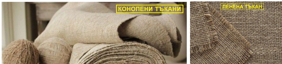
Фиг. 3. Видове естествени тъкани и влакна за ламинатните композити
