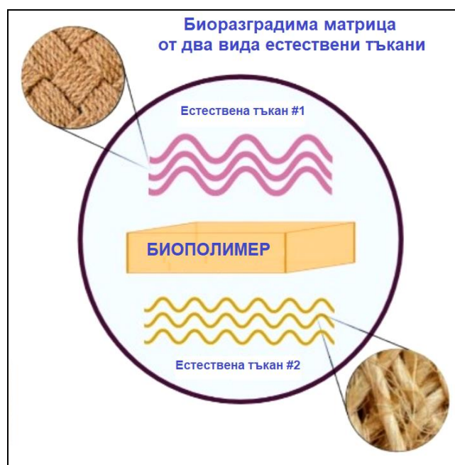
Фиг. 1. Основен модел композит в ракетите „БИО-4“
