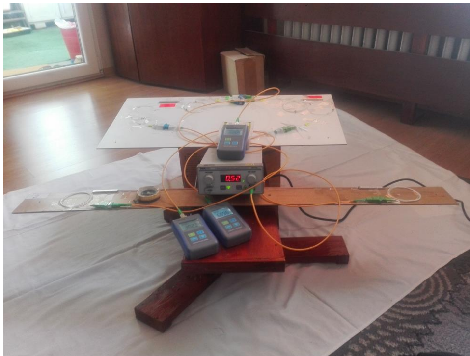
Фиг. 2. Опитна установка на база на Мах-Зендер интерферометър
