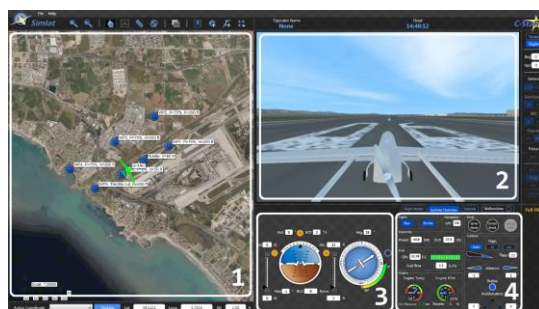
Фиг. 1. Дисплей на тренажора: 1. Маршрутна карта с 7-те маршрутни точки; 2. Видео-канал; 3. Условни данни от навигационно-пилотажните уреди; 4. Информация за полетните системи
