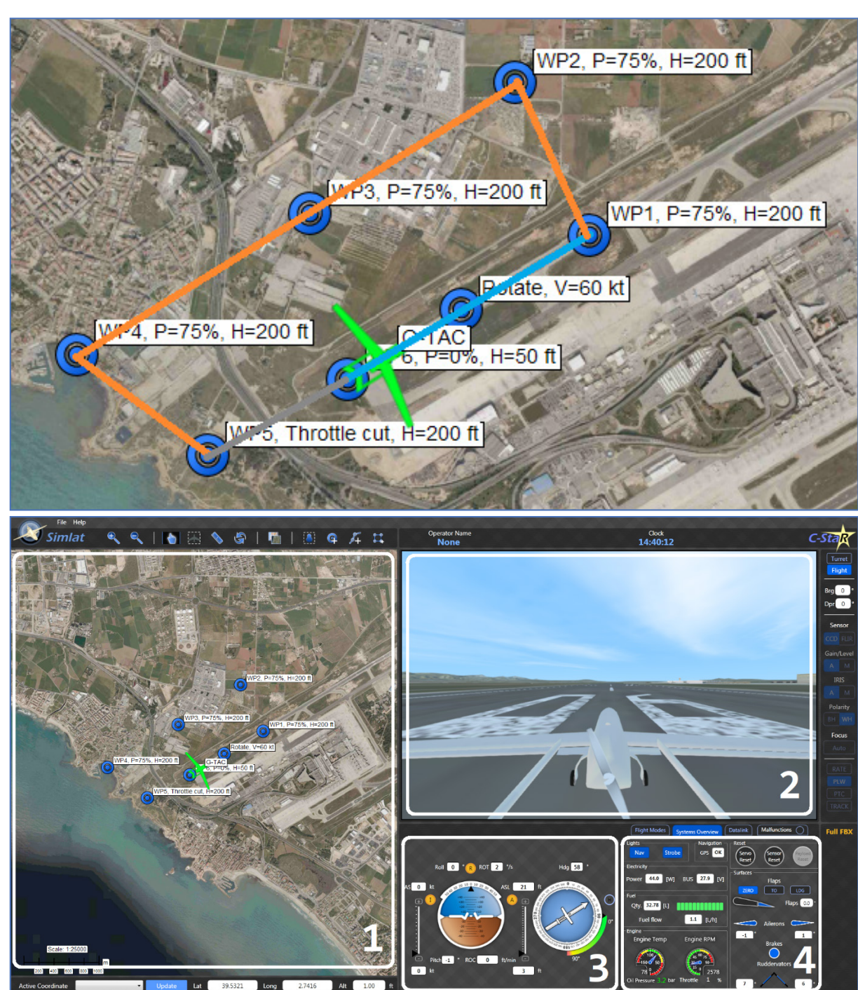
Фиг. 3. Зона на полета с маршрутните точки. Условни данни при провеждане на полета и данни от навигационно-пилотажните уреди
