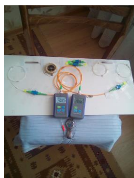
Фиг. 2. Хибриден Мах-Зендер интерферометър № 2
