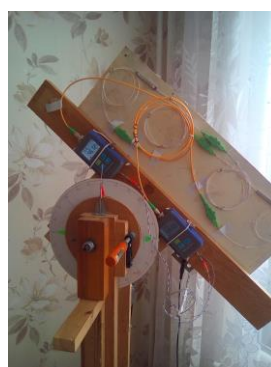
Фиг. 3. Хибриден Мах-Зендер интерферометър № 3
