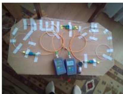
Фиг. 1. Хибриден Мах-Зендер интерферометър № 1
