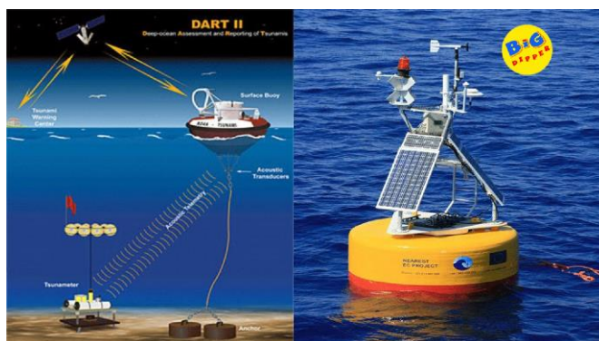
Фиг. 1. Принципна схема за работата на система за ранно оповестяване на вълна цунами [https://www.ndbc.noaa.gov/dart/dart.shtml]
