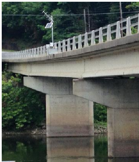
Фиг. 9. Пример за монтирана апаратура за оповестяване на наводнения [https://www.fondriest.com/environmental-measurements/environmental-monitoring-applications/flood-warning-systems/]
