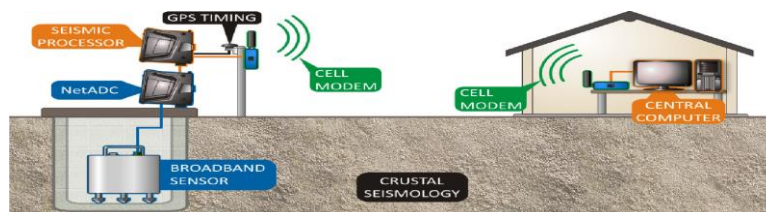
Фиг. 2. Принципна схема за функционирането на сеизмологична мрежа [http://www.imseismology.org/regional-monitoring/]
