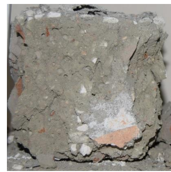
Фиг. 2. Макроструктура на бетонни проби, разрушени при различна температура: а), в) и д) бетон без рециклирани доб. материали; б), г) и е) бетон с рециклирани добавъчни материали
