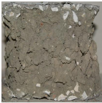
Фиг. 2. Макроструктура на бетонни проби, разрушени при различна температура: а), в) и д) бетон без рециклирани доб. материали; б), г) и е) бетон с рециклирани добавъчни материали
