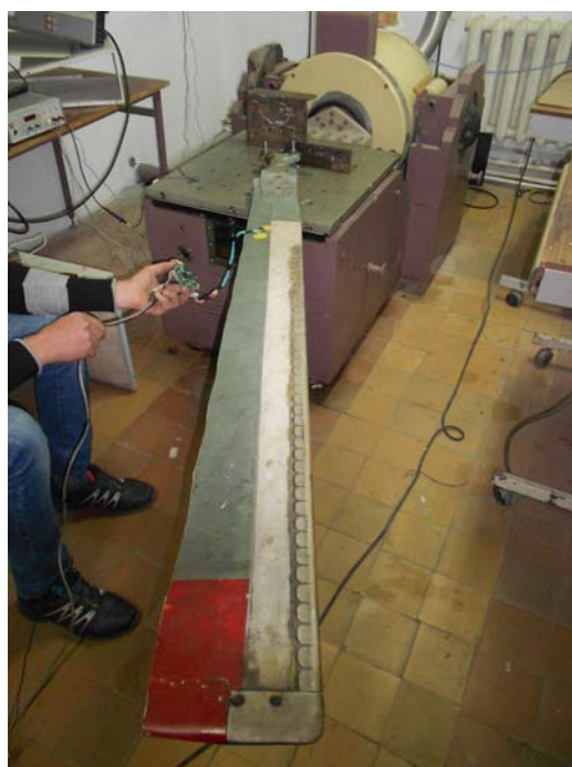
Рис. 6. Фото тестовых испытаний лопасти винта вертолета МИ-8
