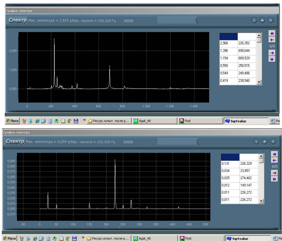
Рис. 5. Примеры записи полученных амплитуд и частот при разных глубинах и длине искусственных трещин в лопасти винта вертолета МИ-8
