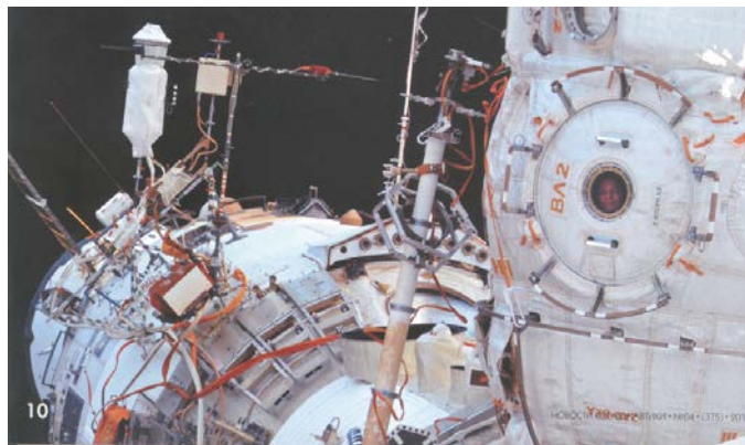
Фиг. 4. Монтираният блок ДП-ПМ, ПВК1 върху повърхността на МКС
