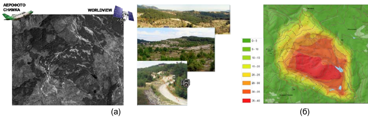
Фиг. 15. Мониторинг на активността на свлачището (а) при с. Генерал Гешево в Източни Родопи и карта на посоката на преместване в метри (б)
