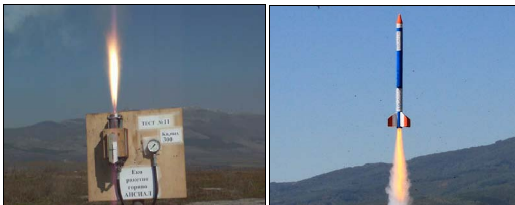
Снимки 2,3. Статичен тест и полетно изпитание на горивни рецептури
