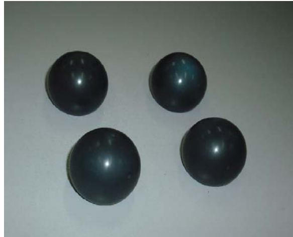
Фиг. 6. Снимки на четири броя керамични глави, уплътнени и покрити със стъкловъглерод
