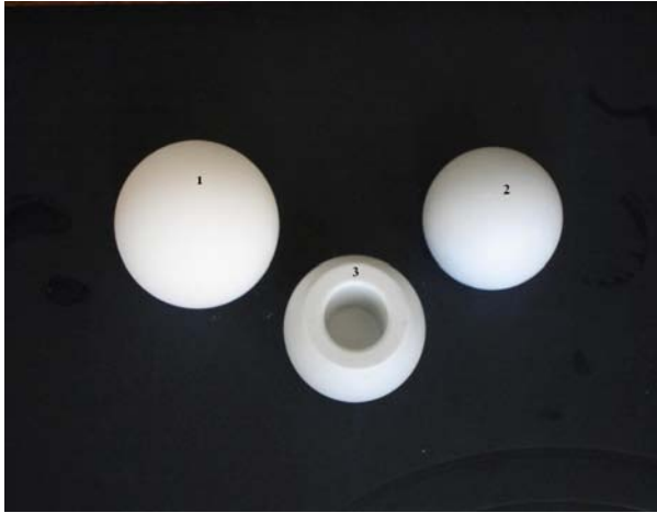
Фиг. 5. Снимка на корундова глава за тазобедрена става: 1-бисквитирана; 2 и 3 окончателно спечени готови за покриване със стъкловъглерод
