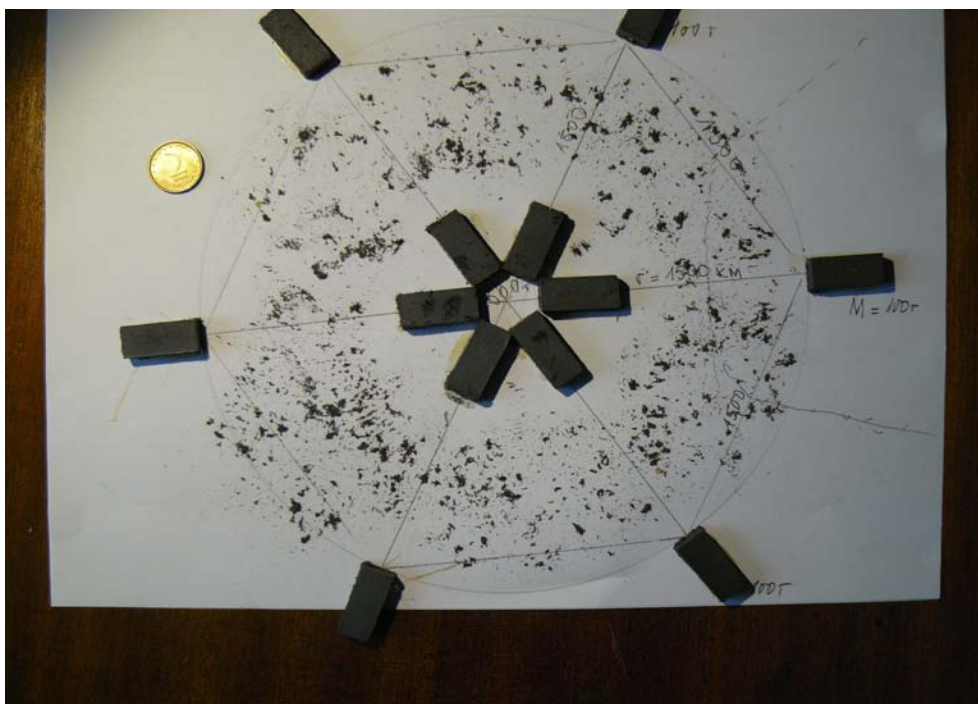
Фиг. 5. Симулация на защитния екран с постоянни магнити и железни частици. Създаване на поле с еднакъв интензитет. Модел на автора. 2013 г. София
