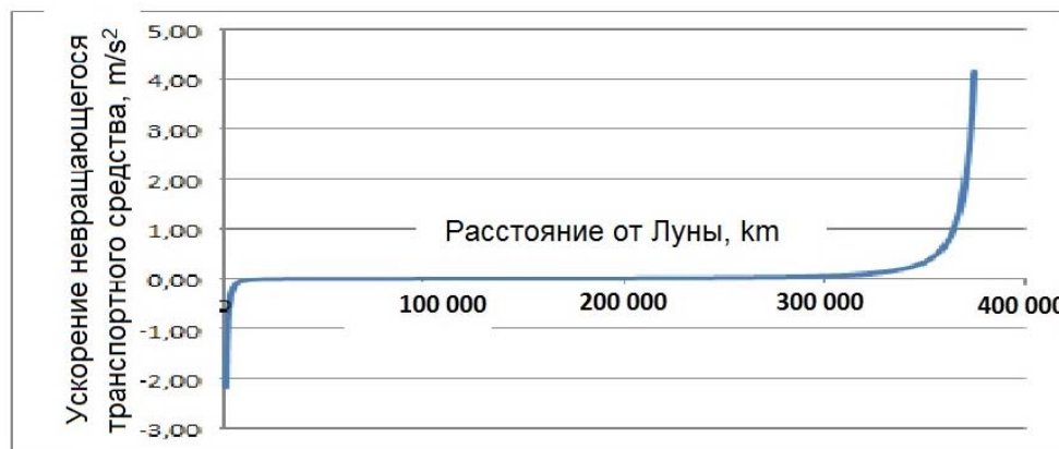
Рис. 2. Ускорения невращающегося транспортного средства в зависимости от его расположения на трассе "Луна-Земля"
