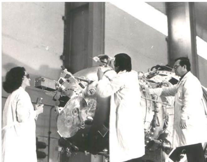
Фиг. 4. а) Геофизичната ракета „Вертикал-4“ с прибор П2Р на старт от космодрума Кап Яр на 14.10.1976 г.; б) Предстартова подготовка на „Вертикал-10“ - Таня Иванова и Евгени Вътев почистват сондата на Ленгмиур на прибор ЗОНД-Р под „зоркото око“ на руския куратор В.Ф.Губский.
