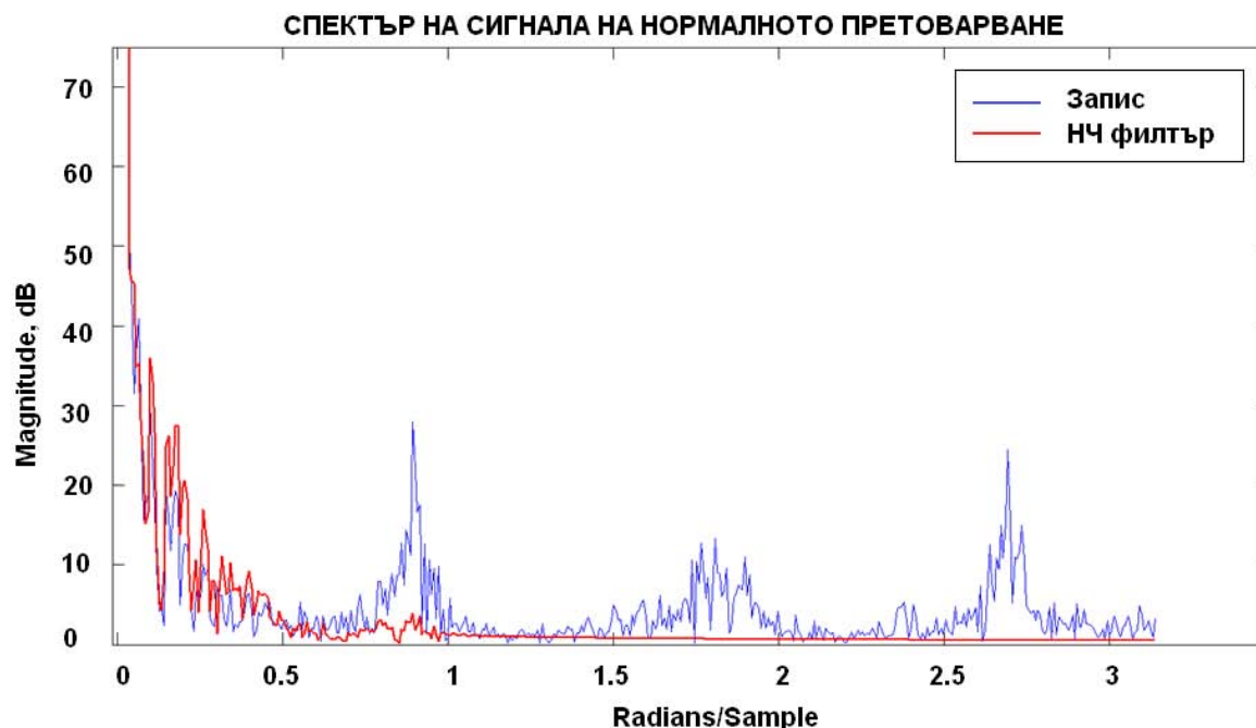
Фиг. 7. Доминиращи честоти в сигнала на нормалното претоварване в следствие вибрации на двигателя, Sample = 20 ms
