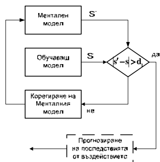
Фиг. 3. Формиране на ММ за прогнозиране последствията от въздействията: S — наблюдаеми сигнали; S' — прогнозирани сигнали; d - праг на коректност на прогнозата
