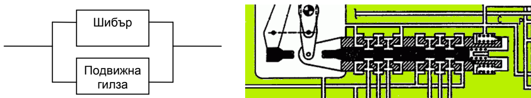
Фиг. 4. Блокова диаграма и принципна схема на сервоклапан
