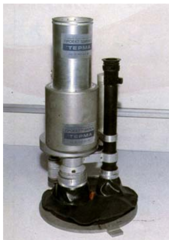
Фиг. 1. Импулсна фотометрична апаратура “Терма”
