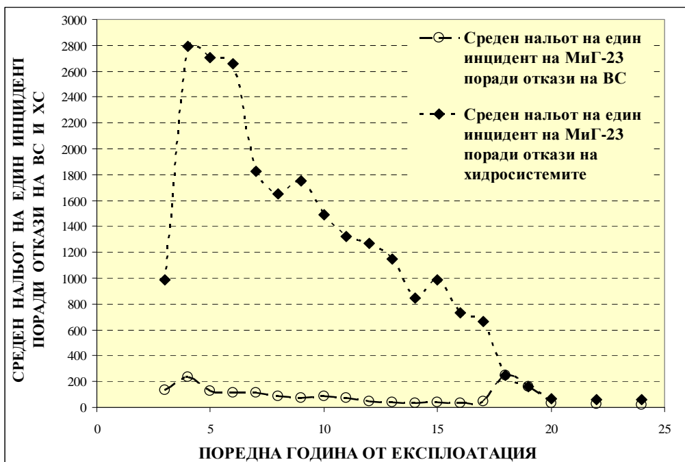
Фиг. 2. Средни нальоти на един инцидент на самолет МиГ-23 поради откази на ВС като цяло и на хидросистемата в зависимост от годините на експлоатация
